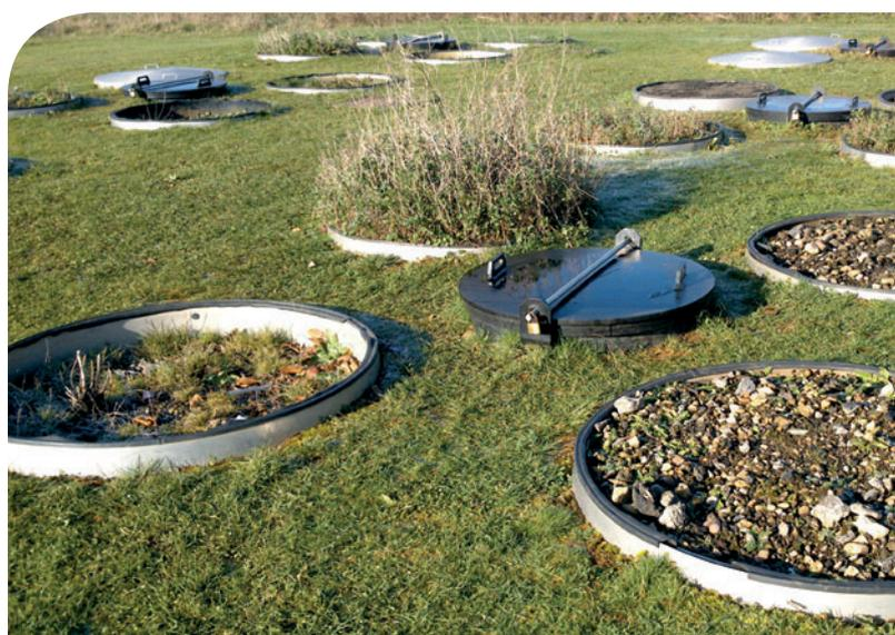
Colonnes lysimétriques - expérimentation de dépollution
